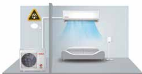
Indikator isticanja rashladnog gasa se aktivirao
