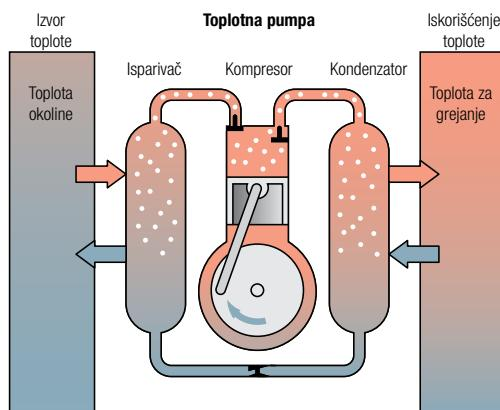
Toplotne pumpe vazduh/voda crpe energiju iz okolnog vazduha, pri čemu ovaj izvor energije nije na potrebnoj temperaturi. Tek toplotna pumpa podiže energiju na potreban temperaturski nivo.
